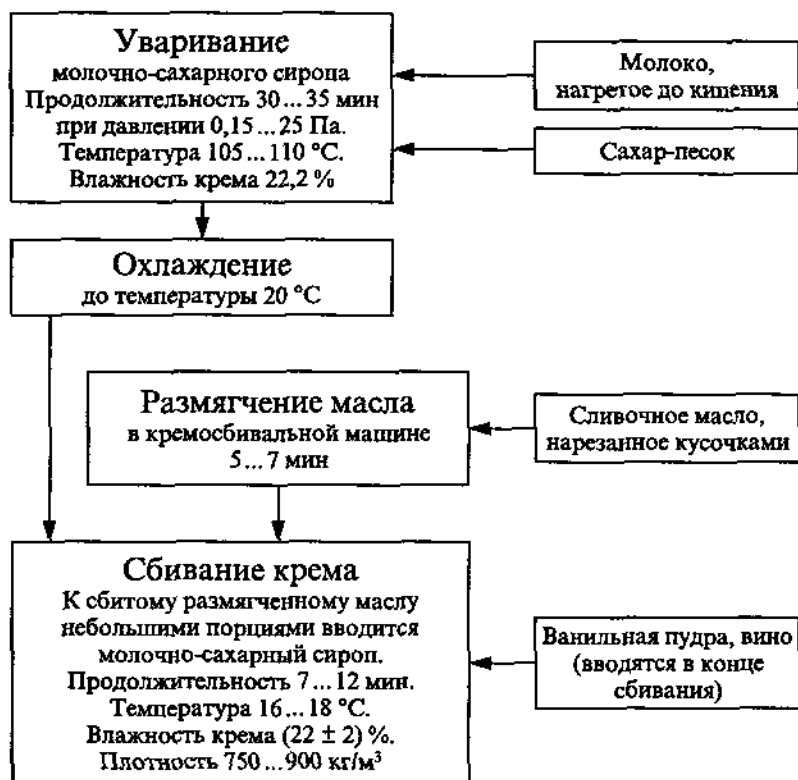
Рис. 30. Технологическая схема получения крема сливочного «Новый» на молочно-сахарном сиропе
