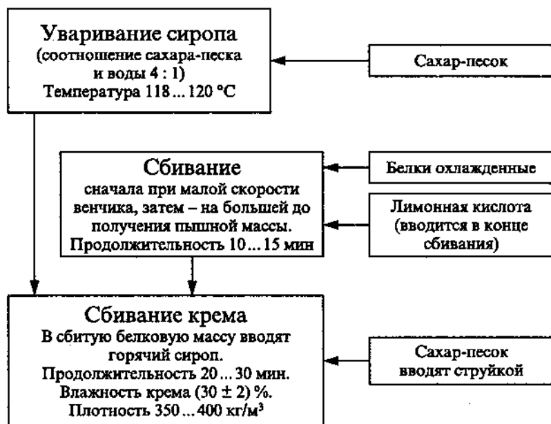
Рис. 32. Технологическая схема производства крема белково-сбивного заварного
